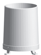
1 raccoglitore di acqua piovana
